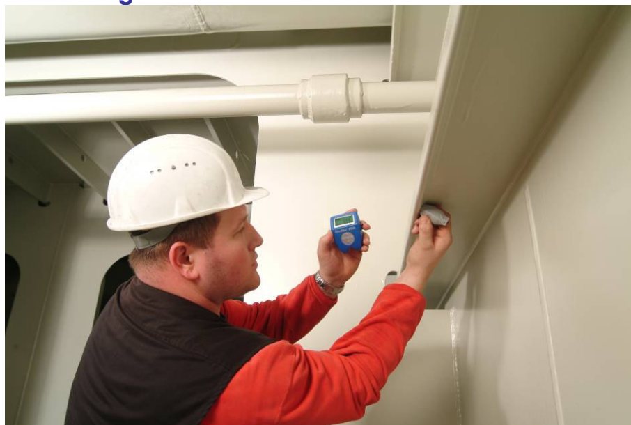
Abbildung 1: Beschichtungskontrollen an schwierigen Positionen mit dem Schichtdicken-Messsystem QNix® 8500 und einer kleinen funkbasierten Messsonde
