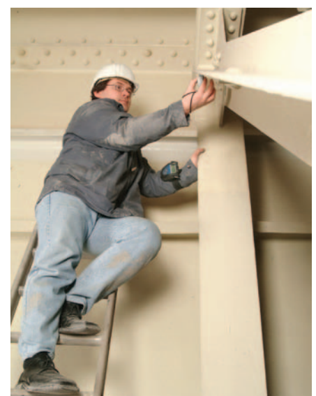
Bild 5. Komfortable Schichtdickenmessung mit Qnix® sat-Funkmeßsonde auf einer Leiter
