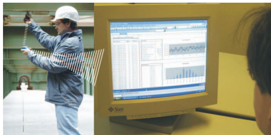
Bild 7. Funkübertragung von der Meßsonde zum Handgerät sowie vom Handgerät zu einem Computer, wo die Datenauswertung mittels Microsoft-Excel geschieht
