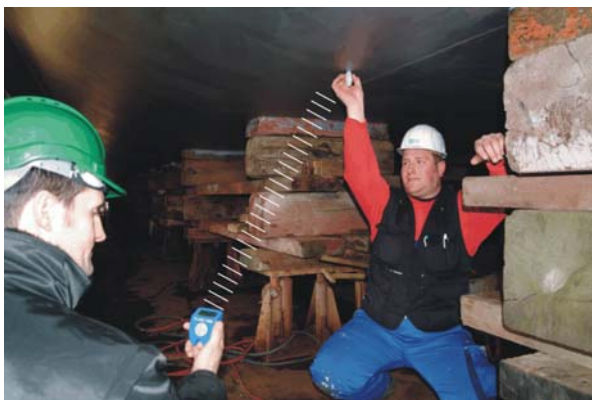
Abbildung 4: Komfortable Schichtdickenkontrollen mittels funkbasierter Messdatenübertragung (im Bild das modulare Mess-System QNix® 8500 mit der Funk-Sonde QNix® sat)
