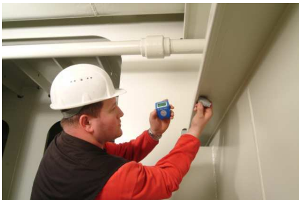
Abbildung 3: Schichtdickenmessung auch an schwer zugänglichen Stellen mit kleinen Mess-Sonden (im Bild das modulare Mess-System QNix® 8500 mit der Funk-Sonde Q-Nix® sat)
