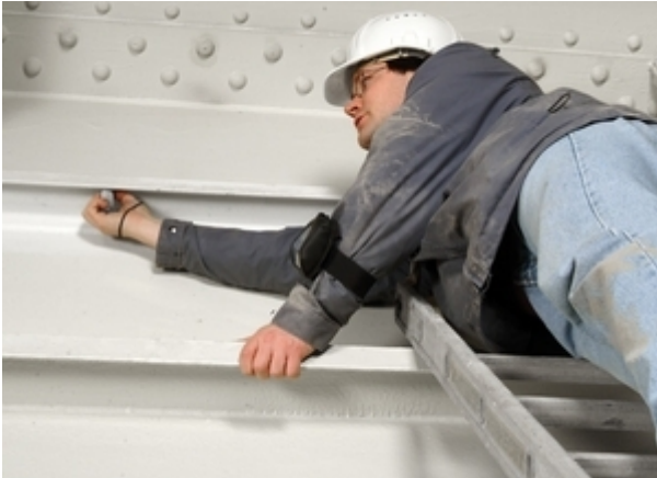
Die funkbasierte Schichtdicken-Messsonde QNix® sat: Messen wo der Daumen Platz hat
